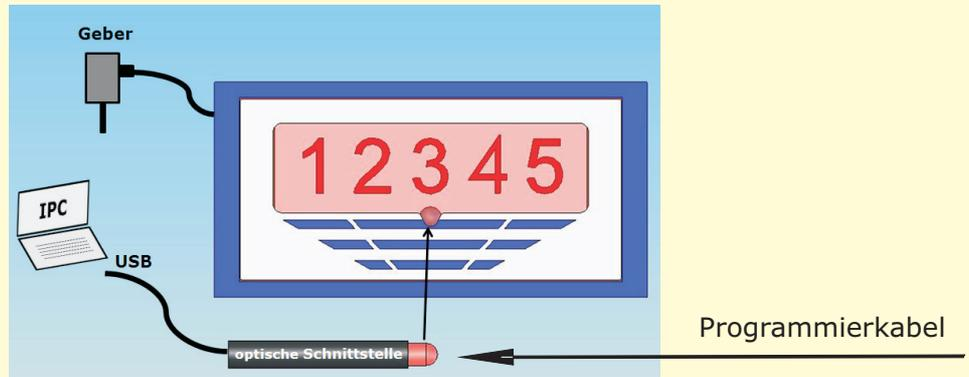
Die Programmierung der Messanzeige erfolgt über eine optische Schnittstelle.
